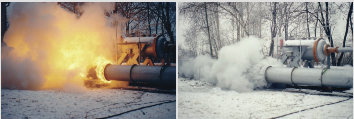
Abbildungen aus seiner Versuchsreihe: Staubexplosion in einer Rohrleitung ohne und mit RSBP HRD-Löschmittelsperre
